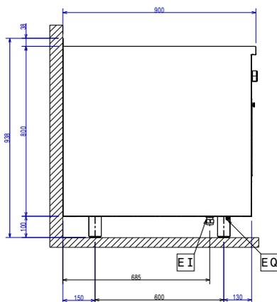
EI = Conexión eléctrica (energía)
